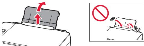
2 Abra a tampa do slot de alimentação e deslize a guia do papel do lado direito para a extrema direita.
