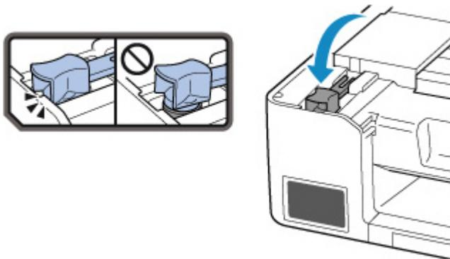
8. Schließen Sie das/die Scan-Modul/Abdeckung.
