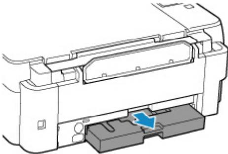
6. Heben Sie die Wartungskassette leicht an und ziehen Sie sie heraus.
