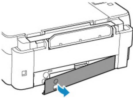
5. Ziehen Sie die Wartungskassette bis zum Anschlag heraus.
