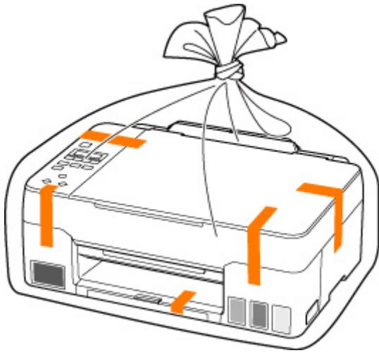
15. Polstern Sie den Drucker beim Einpacken des Druckers im Karton mit Schutzmaterial.
