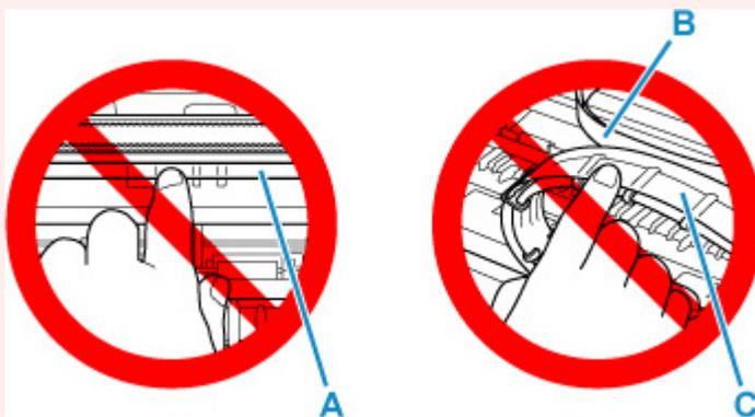
Der Drucker kann beschädigt werden, wenn Sie dieses Teil durch Papier- oder Handberührungen verunreinigen oder zerkratzen.
