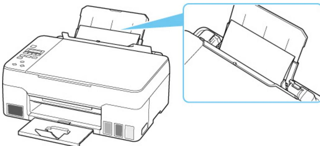
4. Entfernen Sie den Fremdkörper manuell mit dem eingelegten Papier.
