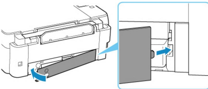
**9. Setzen Sie die Münzschraube in das Schraubenloch ein und drehen Sie sie im Uhrzeigersinn, um sie zu sichern.**
