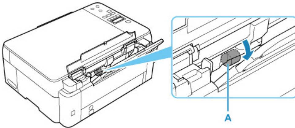
3. Schalten Sie die Stromversorgung ein und reinigen Sie die Papiereinzugwalzen erneut.
