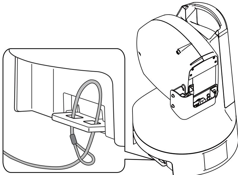
高所への設置や天吊りなど落下する危険性のある場合は、必ずカメラおよび取り付け金具を含む総重量に十分耐えうる市販の落下防止用ワイヤーを2つの通し穴に通し、ワイヤーを丈夫なところに固定してください。
