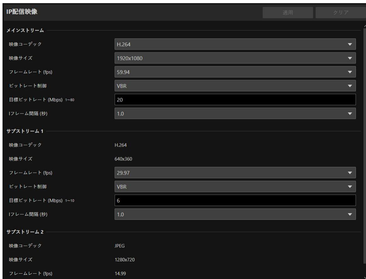
[システム] > [システム] > [環境] で設定したフレーム周波数によって、各映像ストリームごとに選択できる [映像サイズ]、[フレームレート (fps)] の選択肢が異なります。
