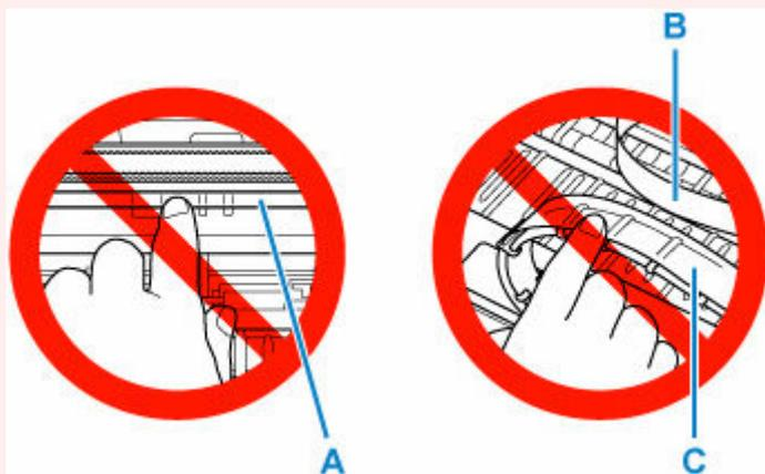
Der Drucker kann beschädigt werden, wenn Sie dieses Teil durch Papier- oder Handberührungen verunreinigen oder zerkratzen.
