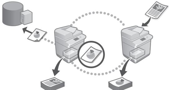
Puteți înregistra un server Windows sau Spațiu avansat al altor imprimante multifuncționale Canon ca destinație de conectare. Acest lucru vă permite să utilizați aparatul pentru a imprima date care se află pe destinația de conectare. De asemenea, puteți utiliza destinația de conectare pentru a obține date din Spațiu avansat al aparatului.
