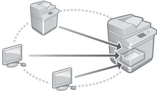
Spațiul de stocare al aparatului are un spațiu partajat, denumit „Spațiu avansat”. Utilizând Spațiu avansat, puteți cu ușurință să partajați fișiere cu computere și cu alte imprimante multifuncționale Canon, fără să fie nevoie de un server.
