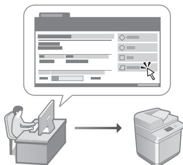
Remote UI (Uzak Kullanıcı Arabirim), bu makinenin bir bilgisayarda web tarayıcı kullanılarak yönetilebilmesine olanak tanır. Bu arabirim; makinenin çalışma durumunu kontrol etmek, ayarlarını değiştirmek ve öğeleri Adres Defteri'ne kaydetmek için kullanabilirsiniz.
