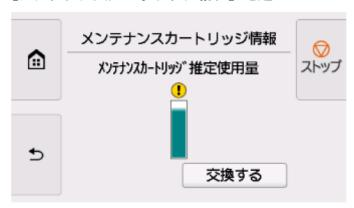
タッチスクリーンにメンテナンスカートリッジの交換を指示するメッセージが表示されたら、メンテナンスカートリッジを交換してください。
