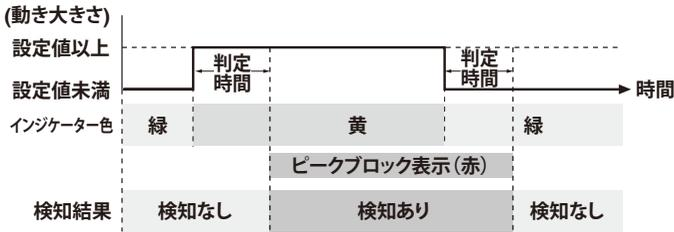
動きが [ 大きさ ] 以上の状態が判定時間以上続いたときに、[ 検知あり ] の状態になり、ピークブロックが表示されます。ピークブロックが表示される [ 検知あり ] の状態で、設定した大きさ未満になっても、判定時間だけ [ 検知あり ] の状態を維持します。
