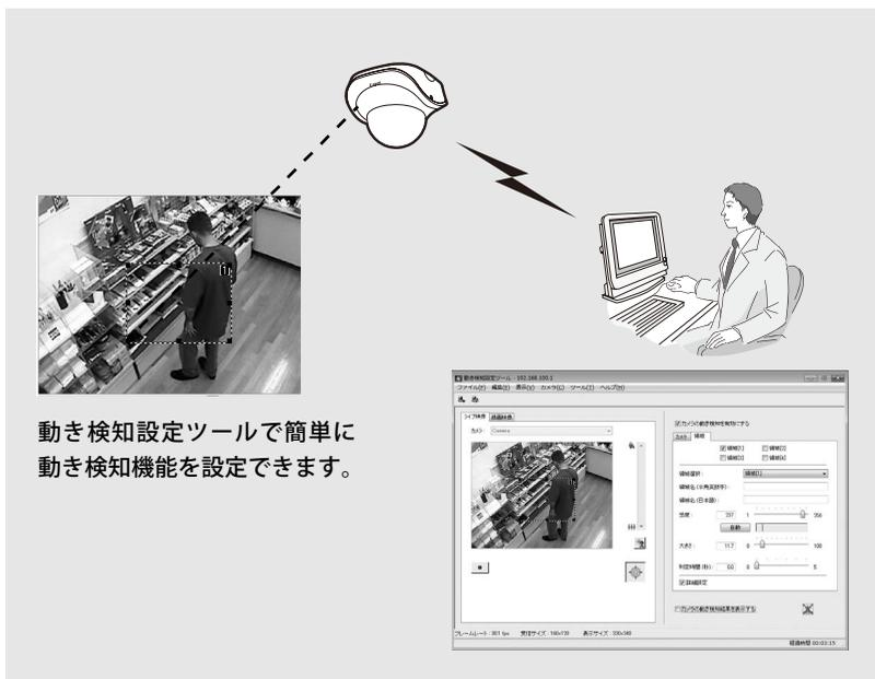
動き検知度は、ビューワー上の動き検知領域枠内の映像に変化が生じた場合、1. どの程度変化したら [感度]、2. 変化した部分の面積がどのぐらいの割合になったら [大きさ]、3. 変化の継続がどのぐらいの時間に達したら [判定時間]、本機が [検知あり] 状態となり、イベントアップロードなどの設定した動作を実行するか決めるものです。
