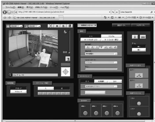
\* カメラ制御権を取得しない状態でも管理者コントロールパネルをオープンすることができますが、管理者コントロール側の操作エリアは、外部入力状態表示と動き検知状態表示を除いてグレースアウト状態で表示されます。
