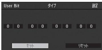
③ ジョイスティックを上下に押しして英数字を選ぶ ▶ ジョイスティックを押す。
