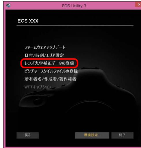
→ [レンズ光学補正データの登録] 画面が表示され、カメラに補正データが登録されているレンズにチェックが入ります。
