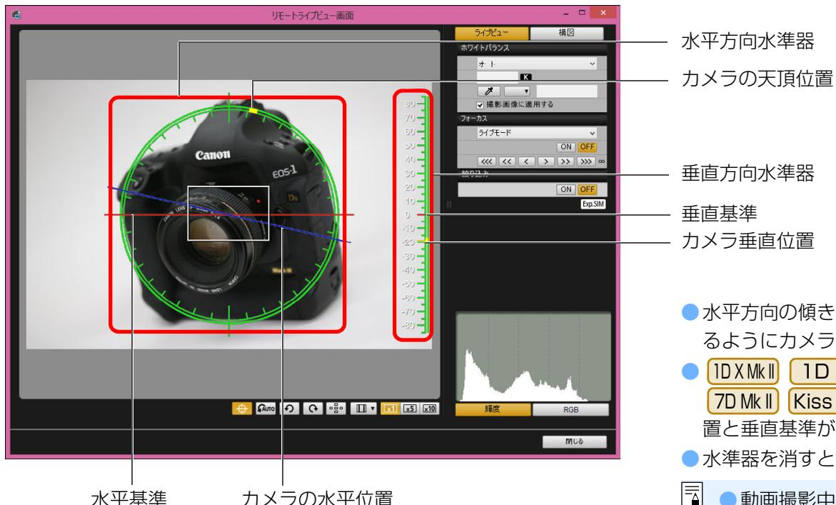
※ 水平方向の 1 目盛は  $10^\circ$  、垂直方向の 1 目盛は  $5^\circ$  です。
