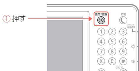
② タッチパネルディスプレーで「調整/メンテナンス」▶【画質調整】▶【自動階調補正】を押す
