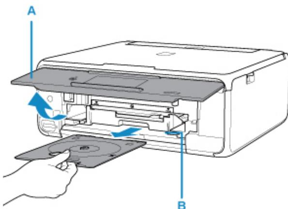
2. Insérez le disque imprimable dans le bac disque avec la surface imprimable orientée vers le haut.
