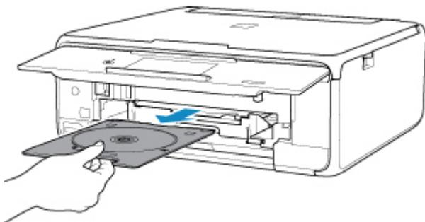
2. Retirez le disque imprimable du bac disque.
