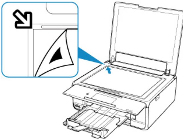
2. Fermez doucement le capot du scanner et sélectionnez **OK** sur l'écran tactile de l'imprimante.
