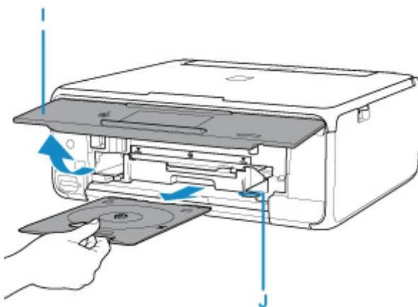
11. Insérez le disque imprimable dans le bac disque avec la surface imprimable orientée vers le haut.
