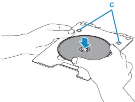
3. Insérez le bac disque dans le guide bac disque.
