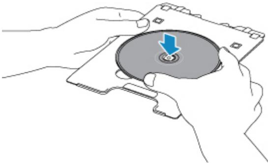
13. Insérez le bac disque dans le guide bac disque.
