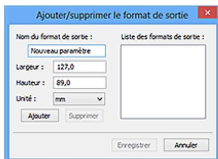
Dans la boîte de dialogue **Ajouter/supprimer le format de sortie**, vous pouvez spécifier plusieurs formats de sortie et les enregistrer simultanément. Les éléments enregistrés s'affichent dans la liste **Format sortie** et peuvent être sélectionnés tout comme les éléments prédéfinis.
