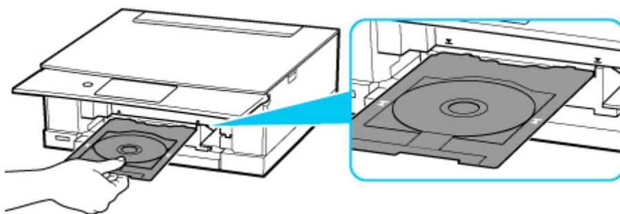
14. Insérez le tiroir multifonctions directement à l'horizontale jusqu'à ce que la flèche (▼) du guide tiroir multifonctions soit à peu près alignée avec la flèche (▲) située sur le tiroir multifonctions.
