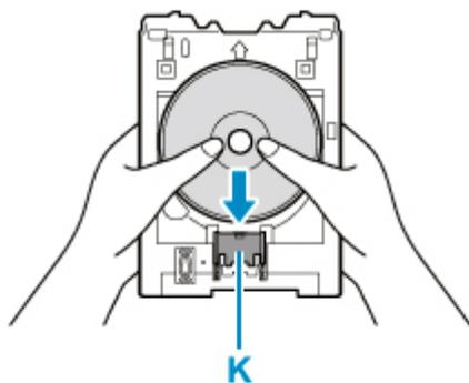
2. Tout en appuyant sur le verrou avec le disque imprimable, insérez la partie supérieure du disque imprimable dans les fentes (L).
