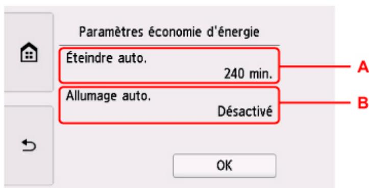
A : Spécifiez la durée au terme de laquelle l'imprimante se met automatiquement hors tension lorsqu'aucune opération n'est exécutée ou qu'aucune donnée d'impression n'est envoyée à l'imprimante.
