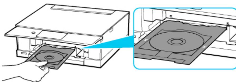
15. Insérez le tiroir multifonctions directement à l'horizontale jusqu'à ce que la flèche (▼) du guide tiroir multifonctions soit à peu près alignée avec la flèche (▲) située sur le tiroir multifonctions.
