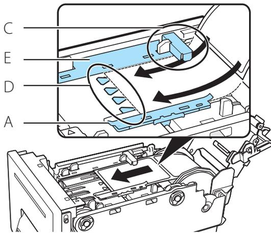
1. 用紙の先端を、センサー（C）の下に通し、紙合わせライン（D）に合わせます。
