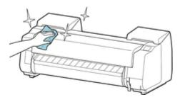
トップカバーと排紙ガイドを開き、用紙に触れる部分(A,B)、センサー部分(C)、トップカバー裏側の窓部分を清掃します。
