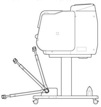
バスケットアームを固定する場合は、左右のバスケットアーム(A)にバスケット固定部材を取り付けてください。
