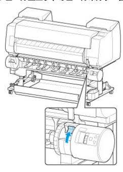
7. ホルダーストッパーが左側にくるようにフランジ(A)の部分を持ち、ロールホルダーの軸をロールホルダースロットの左右のガイド溝(B)に合わせてセットする
