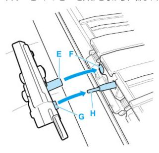
10. 交換用のカッターブレードに付属の固定用の部品を、カッターブレードの中央に合わせて取り付ける
