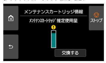
タッチスクリーンにメンテナンスカートリッジの交換を指示するメッセージが表示されたら、メンテナンスカートリッジを交換してください。
