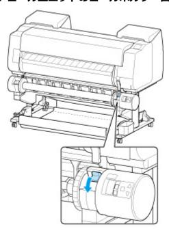
9. ロールユニット上面の給紙フラップスイッチを、スイッチの指標(A)が巻き取りアイコン上の●(B)の位置に合うように切り替える
