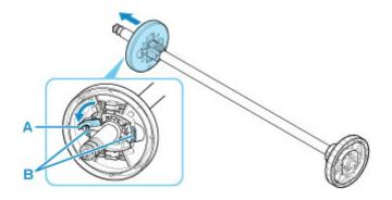
2. 3 インチ紙管の用紙を使用する場合は、3 インチ紙管アタッチメントのツメ(A)をロールホルダーの穴(B)に合わせて、しっかりと差し込む
