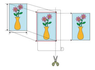
三辺フチなし印刷機能では、用紙サイズがロール紙の幅に合わない場合に、用紙の三辺のみをフチなしで印刷します。
