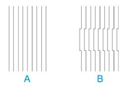
A:線がまっすぐな例 B:線がずれている例
