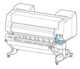
6. 使用済みのメンテナンスカートリッジのつまみ(B)を片手で持って引き出し、もう一方の手でメンテナンスカートリッジの底面をしっかり持って水平に取り出す
