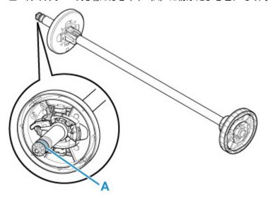
快適にご使用いただくために、音が鳴り始めたら、以下の手順でギヤを清掃してください。
