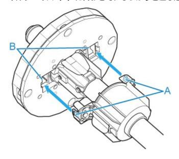
3. 図のように、ロール紙の先端を手前側に向けて、ロール紙の右側からロールホルダーを差し込み、ロール紙が、ロールホルダーのフランジ(A)に隙間なく突き当たるまでしっかりと差し込む
