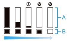
タッチスクリーンにインクタンクの交換を指示するメッセージが表示されたら、インクタンクを交換してください。また、インクの残量確認を指示するメッセージが表示された場合や、インクを大量に消費する長尺印刷、ヘッドクリーニングなどの場合は、残量を確認し、必要に応じてインクタンクを交換してください。
