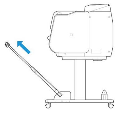
• バスケットアームを長くする場合には、先にバスケットロッド(タグ側)の右端にあるバスケット巻戻しボタンを押しながらバスケットが巻き取られていない状態に戻してから操作してください。
