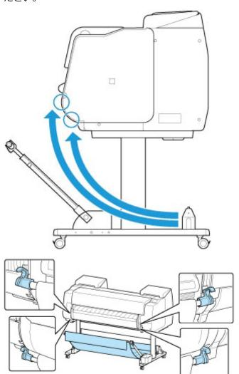
• バスケットロッド (ひも側) をプリンター本体の前面に取り付ける際には、ロッドの両端の (A) の部分が取り付け部にしっかり引っかかっていることを確認してください。
