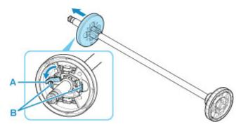
3. 内径が 3 インチの紙管でロール紙を巻き取る場合は、ロールホルダーとホルダーストッパーに 3 インチ紙管アタッチメントを差し込む
