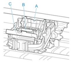
**A:プリントヘッド固定カバー** プリントヘッドを固定します。
