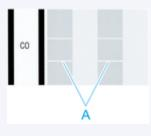
横線がかすれていたり抜けている場合は、プリントヘッドのクリーニングを実行してください。
