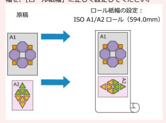
• 上段と下段にセットされているロール紙の用紙種類が異なる場合は、印刷ジョブで指定された用紙の種類が一致する方のロール紙に印刷されます。
