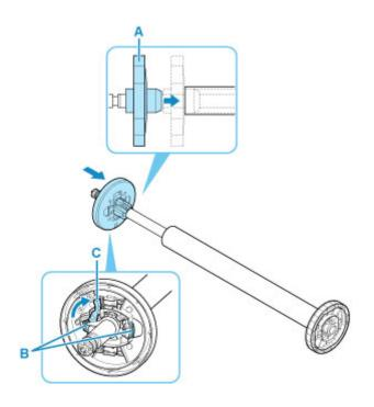
6. ロールユニットのロールホルダー固定スイッチを解除の位置に切り替える
