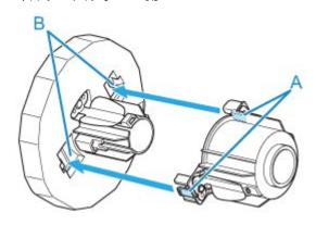
4. ロール紙を巻き取るための芯となる紙管をロールホルダーに差し込む
