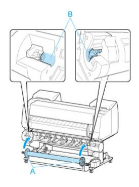
8. ロールユニットのロールホルダー固定スイッチをロックの位置に切り替える
