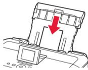
Utilisez **uniquement** le **réceptacle arrière** pour le chargement du papier photo. Lorsque vous utilisez ce type de papier, il vous faut modifier les paramètres de la machine relatifs au type et au format de support. Pour plus d'informations, reportez-vous au **Manuel en ligne**, qui sera installé ultérieurement.
