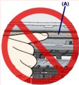
Si du papier ou vos mains entre/entrent en contact avec le film transparent et le salit/salissent ou l'érafle/l'éraflent, cela risque d'endommager la machine.
