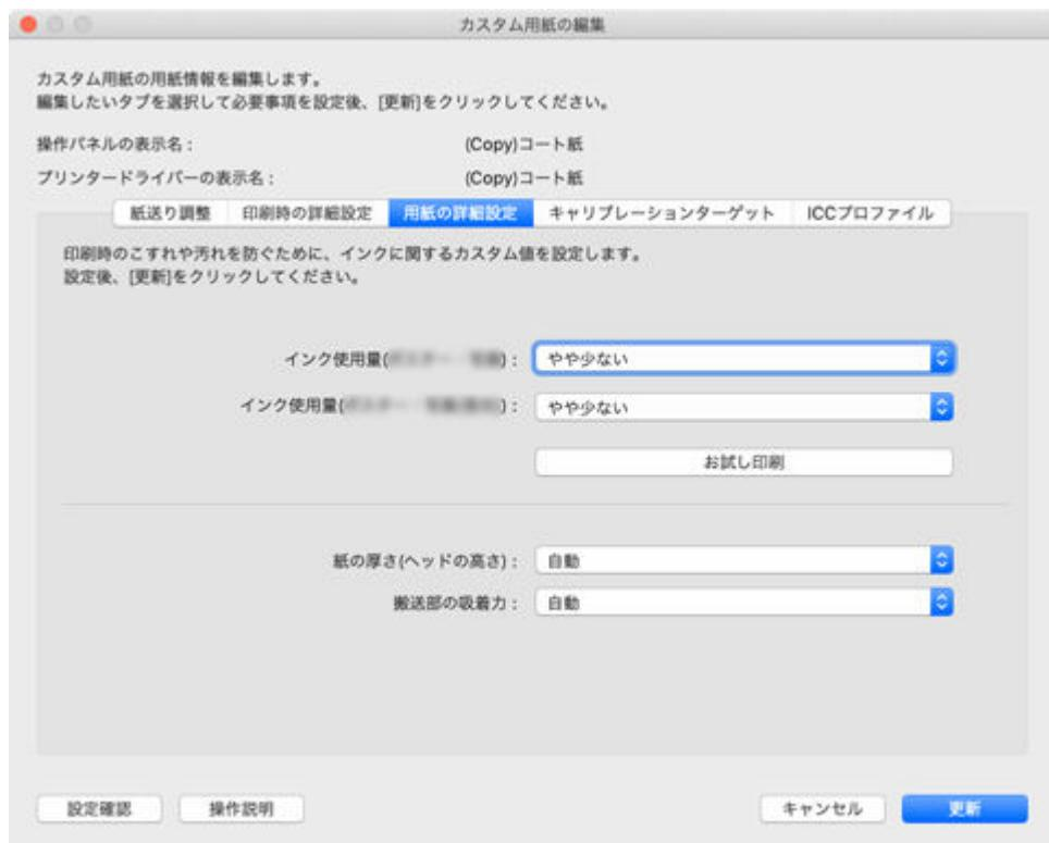
インクのにじみやかすれがないか、お試し印刷の結果を見て最もよいと思われるインク量レベルを判断し、設定します。
