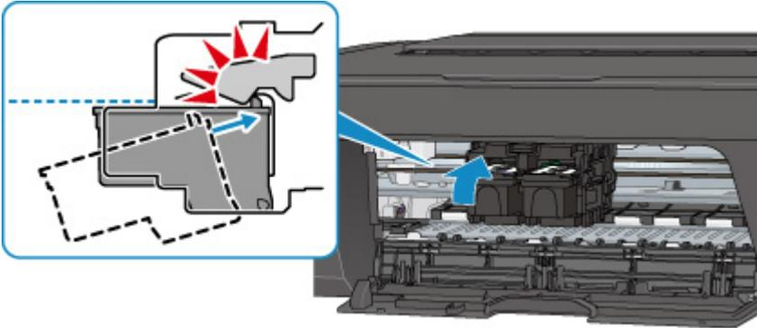
Schließen Sie die Abdeckung, nachdem Sie sichergestellt haben, dass die FINE-Patrone richtig eingesetzt ist.
