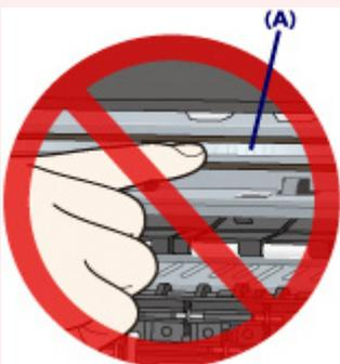
Wenn Sie die durchsichtige Folie mit Papier oder den Händen berühren und Kratzer oder Flecken darauf hinterlassen, kann der Drucker beschädigt werden.
