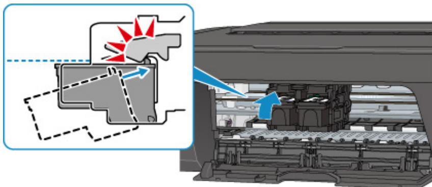
Schließen Sie nach dem Einsetzen die Abdeckung.
