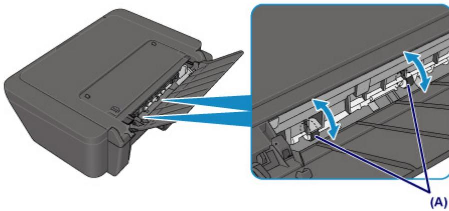
Schalten Sie das Gerät nach der Reinigung der Papiereinzugwalzen ein und reinigen Sie die Papiereinzugwalzen dann erneut.
