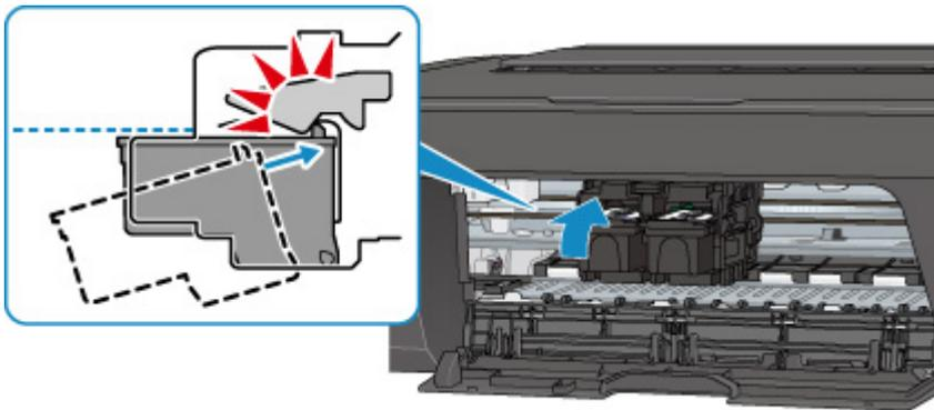
Schließen Sie die Abdeckung, nachdem Sie sichergestellt haben, dass die FINE-Patrone richtig eingesetzt ist.
