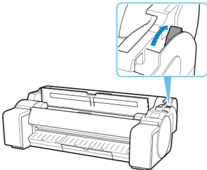
4. 用紙の右端をプリンター本体の右側の紙合わせライン (A) の延長線上に合わせながら、印刷を開始したい任意の位置をプラテンの奥側の溝 (B) に合わせてセットする
