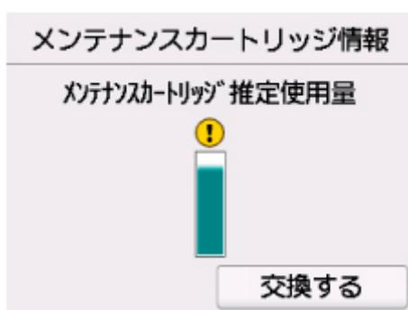
タッチスクリーンにメンテナンスカートリッジの交換を指示するメッセージが表示されたら、メンテナンスカートリッジを交換してください。
