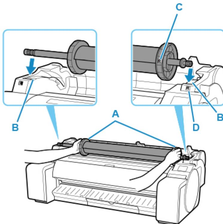
5. ロールホルダーのフランジ (A) を持って、左右のスライドガイド (B) に沿って水平にロールホルダーズロットにセットする
