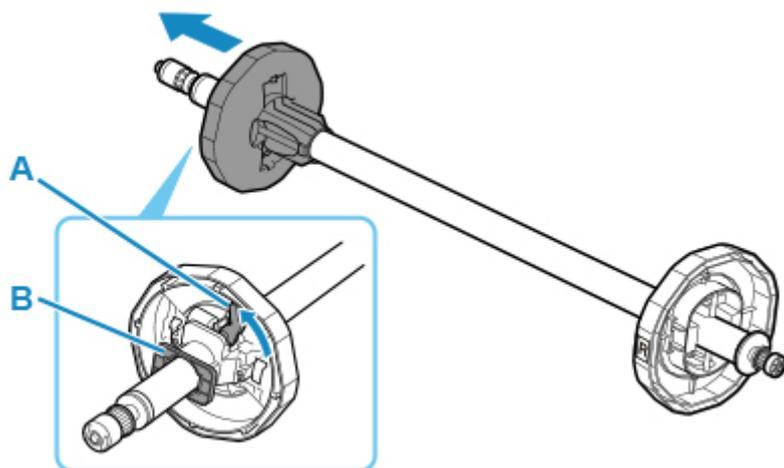
2. 3 インチ紙管の用紙を使用する場合は、3 インチ紙管アタッチメントのツメ (A) をロールホルダーの穴 (B) に合わせて、しっかりと差し込む
