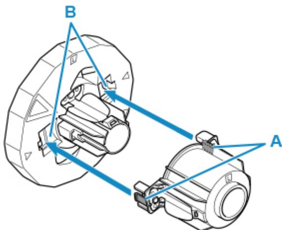
5. 図のように、ホルダーストッパーを左側からロールホルダーに差し込み、図の位置 (B) を持ってホルダーストッパーのフランジ (A) がロール紙に突き当たるまでしっかりと押し込む。ホルダーストッパーのレバー (C) を
