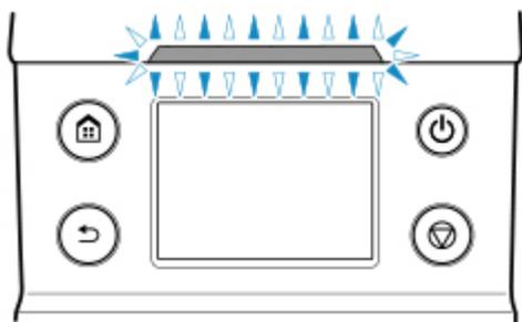
ステータスランプがオレンジ色に点滅している場合は、操作パネルのメッセージを確認して必要な処置を行ってください。
