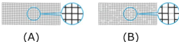
(A) 横線がかすれていない、横線が抜けていない場合は、ノズルは正常です。
