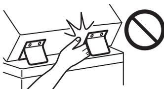
カセットを引き抜いた状態で、本体内部に手を入れない（カセット装着機のみ）
