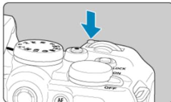
Premendo il pulsante < M-Fn > e ruotando la ghiera < >, è possibile impostare la sensibilità ISO (2), la modalità drive (3), il funzionamento di AF (4), il bilanciamento del bianco (5) e la compensazione esposizione flash (6).
