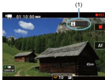
Con l'aumento della temperatura interna, il livello sull'indicatore aumenta verso destra. La velocità di aumento del livello dipende dalle condizioni di scatto. I livelli da 1 a 7 sono contrassegnati in bianco, ma quando la temperatura raggiunge il livello 8, il colore cambia.
