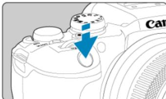
Consente di attivare la messa a fuoco automatica e il sistema di esposizione automatica per impostare, rispettivamente, velocità dell'otturatore e valore di apertura.
