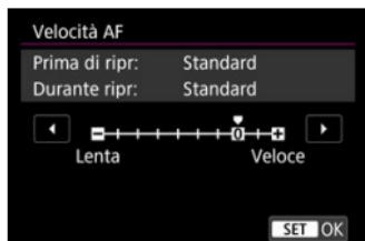
È possibile regolare la velocità dell'AF (velocità di transizione della messa a fuoco) dalla velocità standard (0) a lenta (un livello scelto fra sette) o veloce (un livello scelto fra due) per ottenere l'effetto desiderato per la creazione del filmato.
