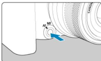
Premere il pulsante di anteprima della profondità di campo per mantenere l'impostazione del valore di apertura corrente dell'obiettivo e controllare l'area messa a fuoco (profondità di campo).
