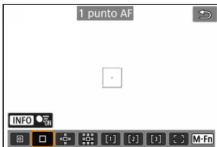
La fotocamera mette a fuoco utilizzando un punto AF singolo [□].
