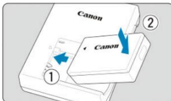
● Eseguire l'operazione inversa per rimuovere la batteria.
