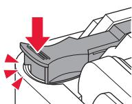
Si el soporte del cabezal de impresión está en el centro de la impresora, compruebe que la cubierta esté cerrada.
