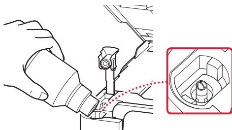
**4** Levante lentamente a garrafa de tinta de cabeça para baixo e empurre para baixo para despejar a tinta.
