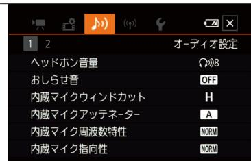
**A** オート カメラがマイクの音量に合わせて、アッテネーターを自動的に入／切します。大音量はひずまない音量に、大音量以外は最適な音量で記録できる。
