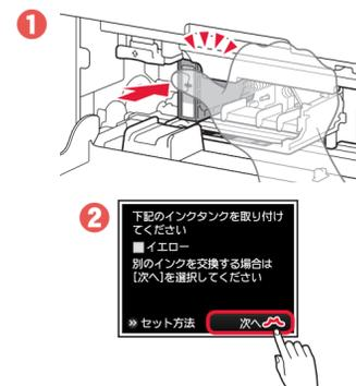
5 残りのインクタンクを、2 ~ 4 と同じように取り付ける
