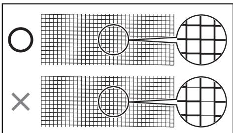
ヘッドクリーニングが終了したら、ノズルチェックパターンを印刷して、確認します。
