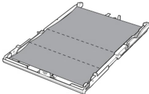
11. カセットカバーを取り付け、カセットを本体に差し込む
