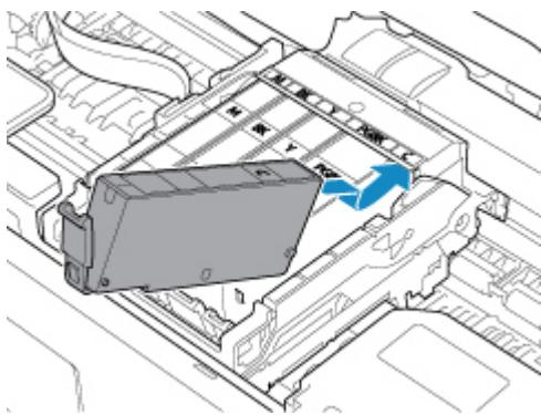
8. インクタンク上面を「カチッ」と音がするまでしっかりと押して、インクタンクを固定する
