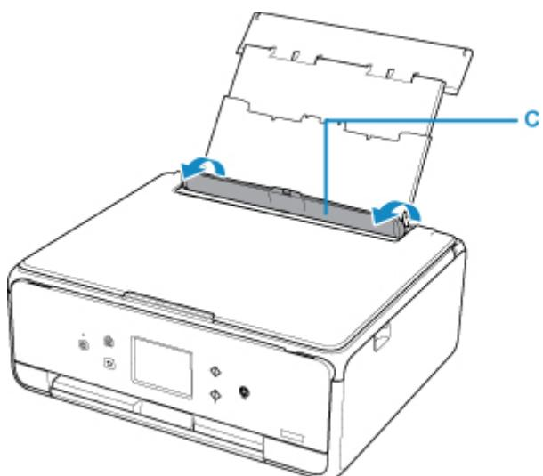
3. 印刷したい面を表にして、用紙を縦にセットする
