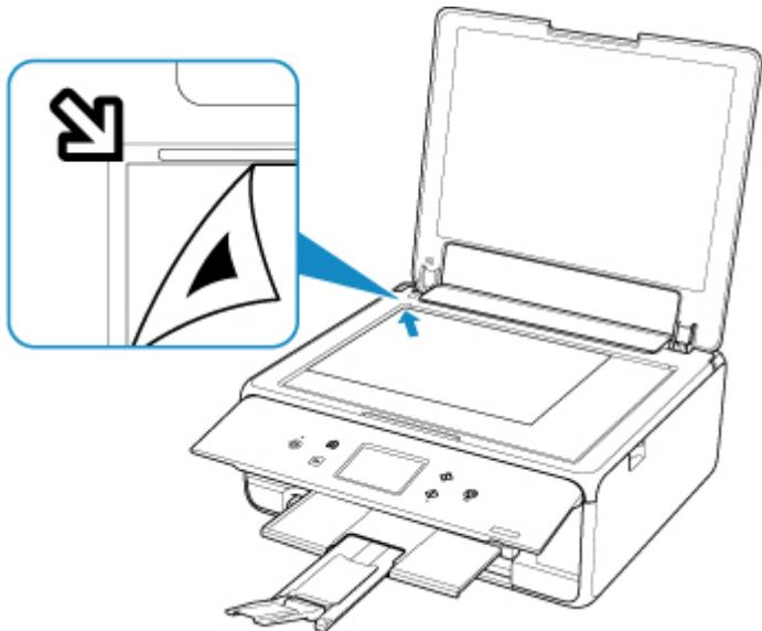
2. 原稿台カバーをゆっくり閉じて、プリンターのタッチスクリーンに表示されている [OK] を選ぶ
