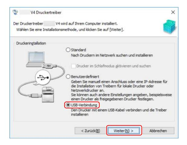
6 Wenn der folgende Bildschirm erscheint, schalten Sie das Gerät ein → verbinden Sie das Gerät und den Computer mit einem USB-Kabel.
