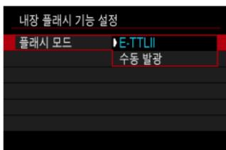
E-TTL II/E-TTL 완전 자동 플래시 모드로 촬영하려면 **[E-TTL II]**로 설정하십시오.
