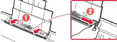
3 Legen Sie mehrere Blätter Papier mit der bedruckbaren Seite nach oben ein und schieben Sie die seitliche Papierführung gegen die Kante des Papierstapels.
