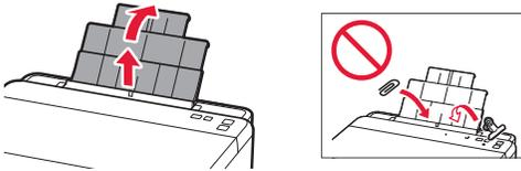
2 Öffnen Sie die Abdeckung für den Einzugschacht und schieben Sie die rechte Papierführung ganz nach rechts.
