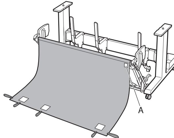
**8** 補助ロッド（A）を補助ロッドホルダー（B）に差し込みます。
