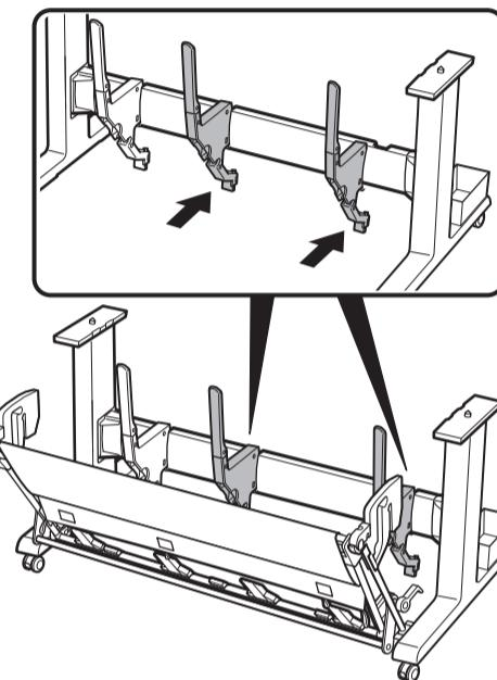
**5** 切り替えストッパーの図の部分（A）をペーパーガイドの穴（B）に挿入し、切り替えストッパーの取り付け部（C）をカチッと音がするまでペーパーガイドに押し込みます。
