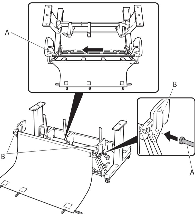
**9** バスケット布を補助ロッドの上に掛けます。
