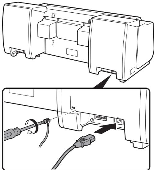
プリンター背面の電源コネクタに電源コードを差し込み、アース端子に市販のドライバを使ってアース線を取り付けます。
