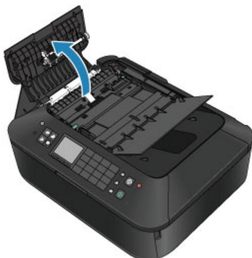
3. Con un panno asciutto, morbido, pulito e liscio, eliminare ogni traccia di polvere dalla parte interna del coperchio dell'alimentatore documenti **(A)**.
