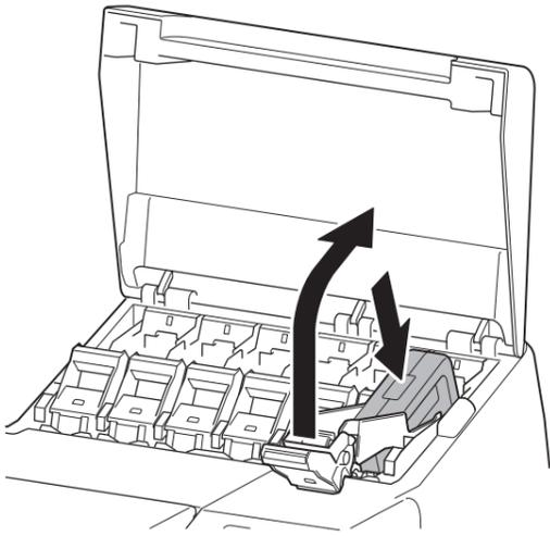
**8** インクタンク固定レバーの持ち手部をしっかりと奥に押し込みます。
