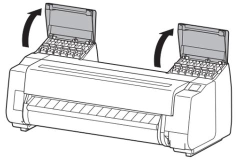
**2** 取り付ける色のインクタンク固定レバーの持ち手部（A）を（B）の
