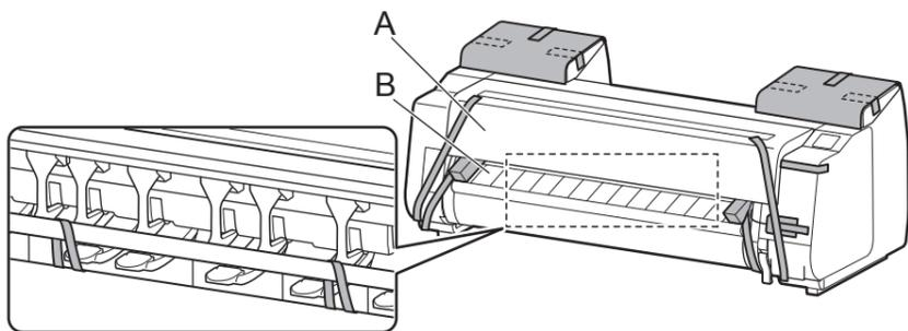
**3** プリンターの左右底面の運搬用取っ手を片側 3 人ずつで持ち、プリンターを持ち上げます。
