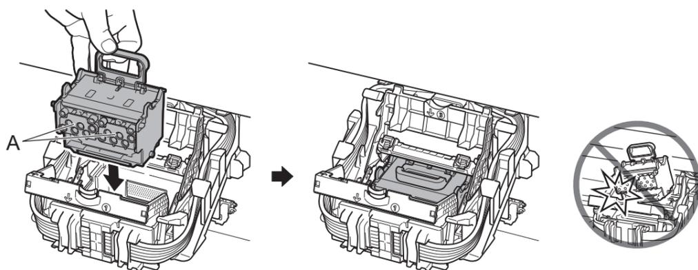
**7** プリントヘッド固定カバー③を前側に倒して、プリントヘッドをロックします。
