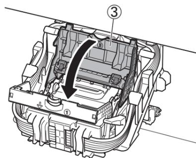
**8** プリントヘッド固定レバー④を「カチッ」と音がするまで奥側に倒します。
