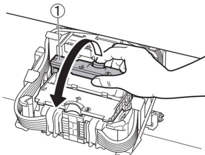
**3** プリントヘッド固定カバー②を中央にあるつまみを持って開きます。キャリッジの電極部 (A) には触らないでください。
