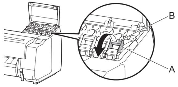
**3** インクタンク固定レバーを止まるまで持ち上げてから、手前に倒します。
