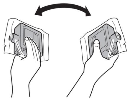
**重要** ・インクタンクを振らないと、インクの成分が沈澱し、印刷品質が低下する場合があります。
