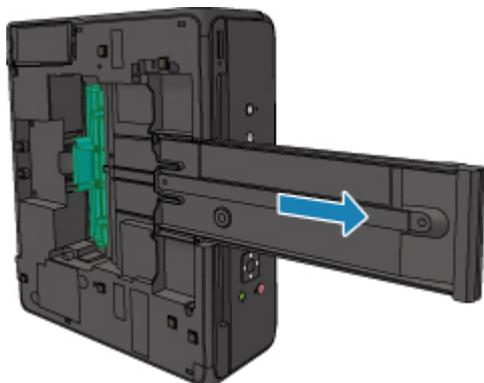
4. Öffnen Sie die Abdeckung an der Unterseite.
