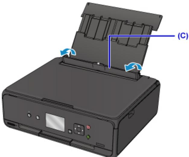
3. Legen Sie das Papier vertikal ein, sodass die ZU BEDRUCKENDE SEITE NACH OBEN ZEIGT.
