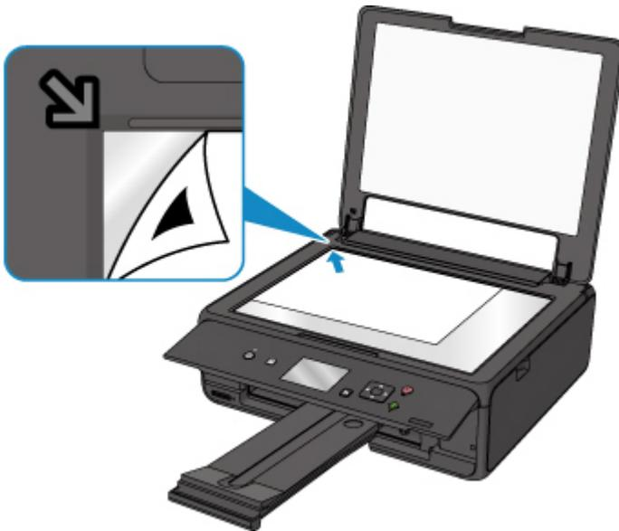
2. Schließen Sie langsam die Vorlagenabdeckung und wählen Sie **OK** auf der LCD-Anzeige aus.
