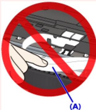
Der Drucker kann beschädigt werden, wenn Sie dieses Teil durch Papier- oder Handberührungen verunreinigen oder zerkratzen.
