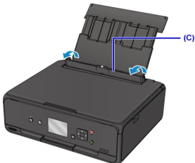
3. Schieben Sie die Papierführungen ganz nach außen. Legen Sie dann die Umschläge so in die Mitte des hinteren Fachs, dass die **ZU BEDRUCKENDE SEITE NACH OBEN ZEIGT**.
