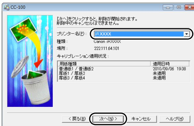
プリンターに転送されているキャリブレーションデータのテーブルがクリアされ、キャリブレーションによる補正が解除されます。
