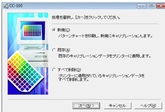
[新規] : カラーキャリブレーションを行い、キャリブレーションデータをプリンターに転送して適用します。プリンターから出力したパターンチャートをスキャナーで読み取り、出力特性の補正値を測定しますので、先にプリンターとスキャナーを使用できる状態においてから操作してください。
