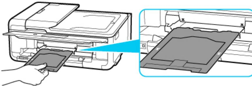
5. Schieben Sie das Multifunktionsfach gerade in horizontaler Richtung ein, bis der Pfeil (▼) auf der Multifunktionsfach-Führung grob am Pfeil (▲) auf dem Multifunktionsfach ausgerichtet ist.
