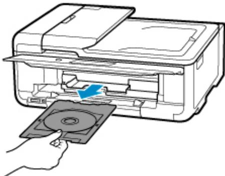
2. Halten Sie die Verriegelung (A) gedrückt, entnehmen Sie den bedruckbaren Datenträger aus dem Schlitz (B) am Multifunktionsfach und entfernen Sie es.
