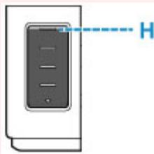
8. Lorsque l'encre atteint la limite maximale, retirez la bouteille d'encre de l'arrivée.
