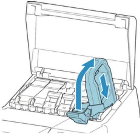
5. Drücken Sie das Griffteil des Sperrhebels für die Tintenpatrone fest hinein.
