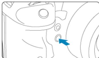
Drücken Sie die Schärfentiefe-Prüftaste, um das Objektiv auf die aktuelle Blendeneinstellung herunterzufahren und den scharfen Bereich (Feldtiefe) zu überprüfen.
