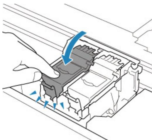
Una vez instalado el cartucho FINE, cierre la cubierta/unidad de escaneado.
