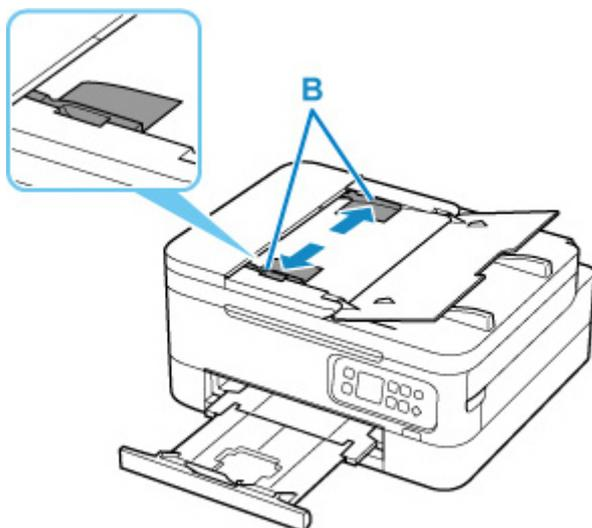
4. Inserte el documento CON LA CARA QUE SE VA A ESCANEAR HACIA ARRIBA en la bandeja de documentos hasta oír un pitido.
