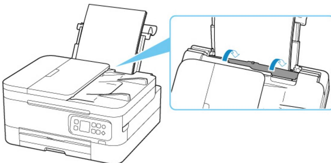
Después de cerrar la cubierta de la ranura de alimentación, la pantalla de confirmación de la configuración del papel para la bandeja posterior se muestra en la pantalla LCD.
