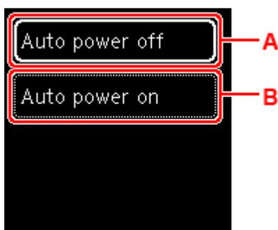
A: Especifique el tiempo que debe transcurrir para apagar la impresora automáticamente si no se realiza ninguna operación ni se envían datos de impresión a la impresora.
