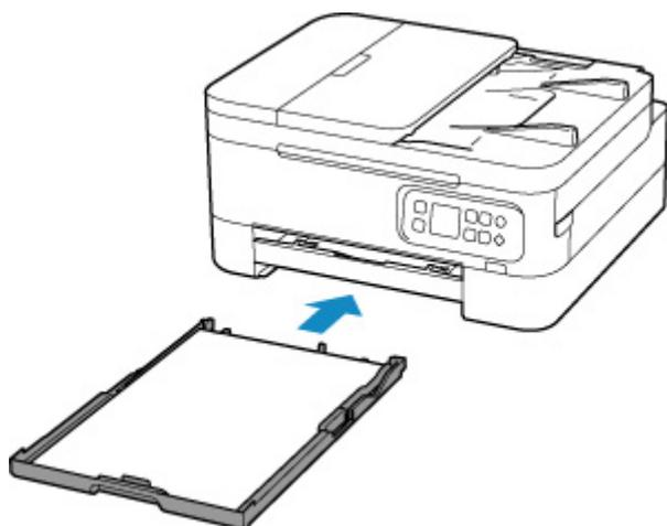
El tamaño del papel se detecta y se define automáticamente en la impresora.
