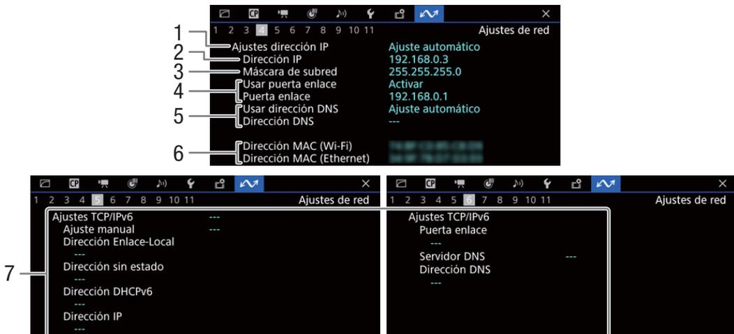
**Ajustes TCP/IP de la conexión de red actual (📖 175)**
