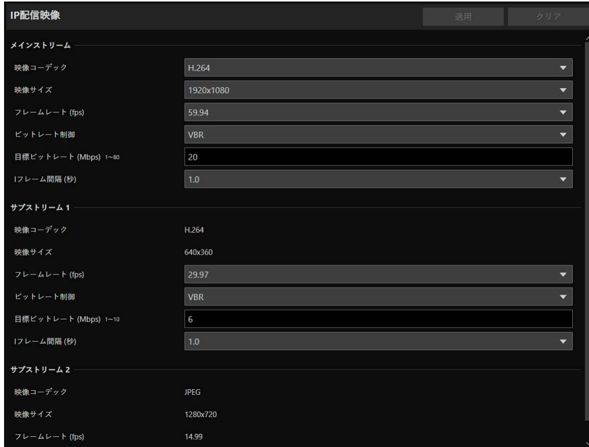
[システム] > [システム] > [環境] で設定したフレーム周波数によって、各映像ストリームごとに選択できる [映像サイズ]、[フレームレート (fps)] の選択肢が異なります。
