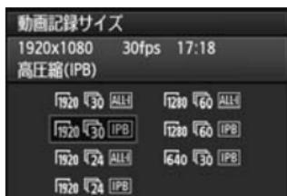
[**4**: 動画記録サイズ] で、動画の画像サイズ、フレームレート（1秒間に何コマ記録するか）、圧縮方式を設定することができます。なお、フレームレートは、[**3**: ビデオ出力方式] の設定により、自動的に切り換わります。
