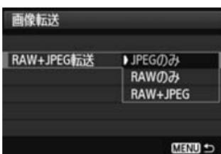
RAW+JPEGで撮影した画像は、どの画像を転送するかを設定することができます。次ページの手順2で [RAW+JPEG転送] を選び、[JPEGのみ] [RAWのみ] [RAW+JPEG] から選びます。
