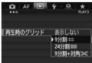
1枚表示、2枚表示（p.259）のときに、再生画像に重ねて格子線を表示することができます。
