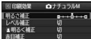
306ページの手順4で項目を選び、〈INFO.〉の横に〈国〉が明るく表示されているときに、〈INFO.〉ボタンを押すと、印刷効果の調整を行うことができます。調整できる（表示される）内容は、手順4の選択内容により異なります。
