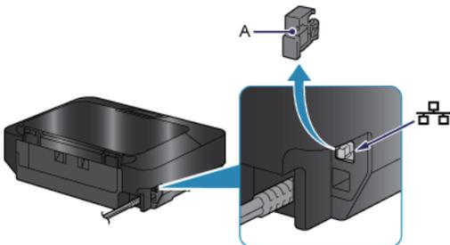
2. Verbinden Sie den Drucker und ein Netzwerkgerät (Router usw.) mit einem Ethernet-Kabel (A).
