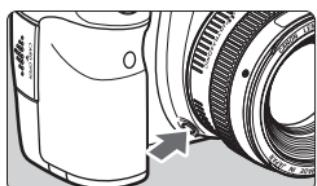
絞り込みボタンを押すと、そのとき設定されている絞り数値でレンズの絞り込みが行われ、実際にピントの合う範囲（被写界深度）を確認することができます。
