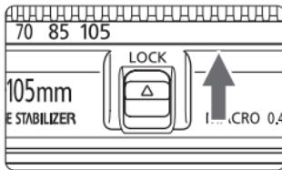
持ち運びの際にズームリングが動いて、レンズが伸び出ることを防ぐことができます。レンズをワイド端（24mm）にして、レンズ側面のズームリングロックレバーを〈LOCK〉方向にスライドさせます。ワイド端以外では、ロックできません。
