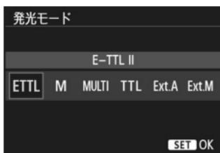
【E-TTL II】は、ストロボの自動撮影ができる、EXシリーズスピードライトの標準的なモードです。
