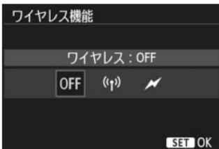
電波通信、または光通信によるワイヤレス（多灯）ストロボ撮影を行うことができます。詳しくは、ワイヤレスストロボ撮影に対応したスピードライトの使用説明書を参照してください。
