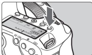
表示パネルの照明は、〈〉ボタンを押すたびに点灯（p.6）／消灯します。なお、バルブ撮影時は、シャッターボタンを全押しすると照明が消えます。
