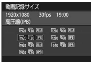
【**2：動画記録サイズ**】で、動画の画像サイズ、フレームレート（1秒間に何コマ記録するか）、圧縮方式を設定することができます。なお、フレームレートは、【**3：ビデオ出力方式**】の設定により、自動的に切り換わります。
