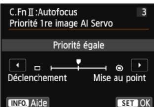
Vous pouvez régler les caractéristiques d'opération AF et le moment de déclenchement de l'obturateur pour la première prise pendant la prise de vue en continu avec autofocus AI Servo.
