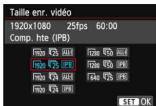
Avec [ 2 : Taille enr. vidéo ], vous pouvez régler la taille d'image, la cadence d'enregistrement des images par seconde et la méthode de compression de la vidéo. La cadence d'enregistrement des images change automatiquement selon le réglage [ 3 : Système vidéo ].
