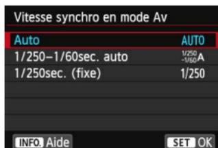
Vous pouvez régler la vitesse de synchronisation du flash pour la photographie au flash dans le mode d'exposition automatique avec priorité à l'ouverture (**Av**).
