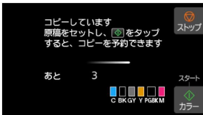
次の原稿をセットして、コピー中の原稿をコピーするときにタッチしたボタン（カラーボタンまたはモノクロボタン）と同じボタンをタッチしてください。
