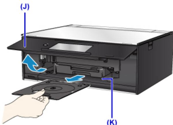
12. 印刷面を上にして、プリンタブルディスクをディスクトレイにセットする
