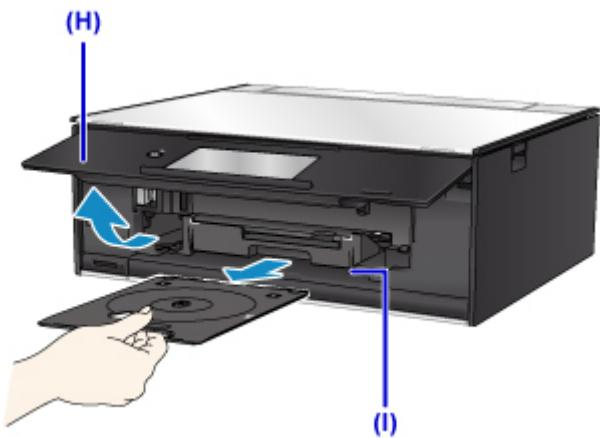
11. 印刷面を上にして、プリンタブルディスクをディスクトレイにセットする
