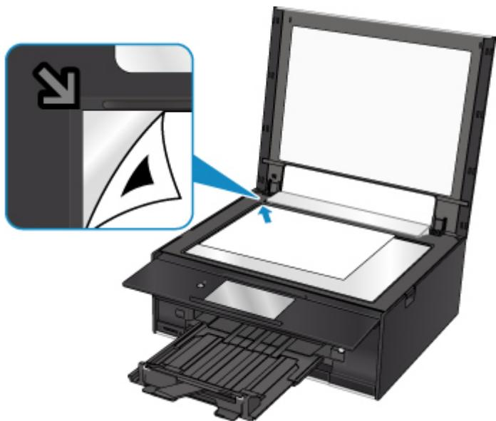
2. 原稿台カバーをゆっくり閉じて、本製品のタッチスクリーンに表示されている [OK] を選ぶ
