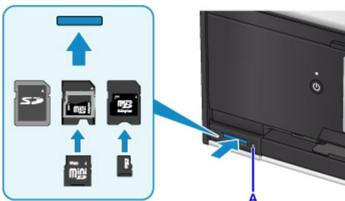
以下のメモリーカードはカードアダプターに取り付けてから、カードスロットにセットしてください。
