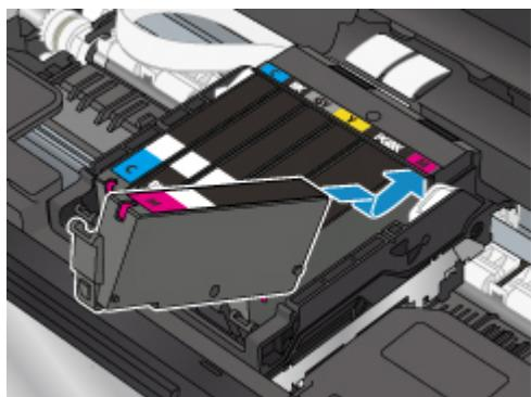
8. インクタンク上面を「カチッ」と音がするまでしっかりと押して、インクタンクを固定する取り付けたら、インクランプが点灯したことを確認してください。
