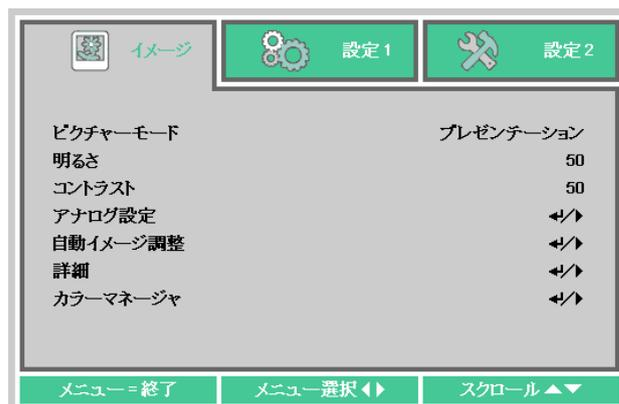
2. カーソル◀▶ボタンを押して、設定1メニューに移動します。カーソル▲▼ボタンを押して、詳細1を選択します。
