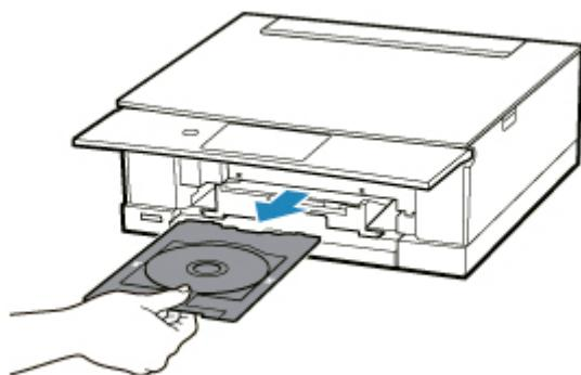
18. ストップバー (K) を押し下げ、プリンタブルディスクを多目的トレイのスリット (L) から外して、取り外す
