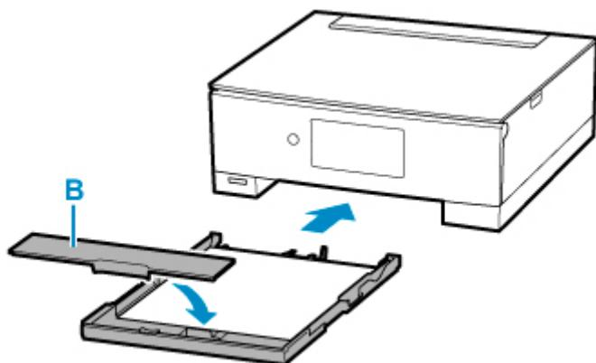
カセットを差し込むと、タッチスクリーンにカセットの用紙の設定を確認する画面が表示されます。
