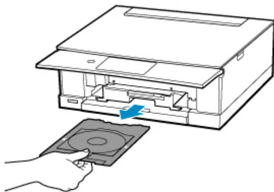
17. スッパー (M) を押し下げ、プリンタブルディスクを多目的トレイのスリット (N) から外して、取り外す
