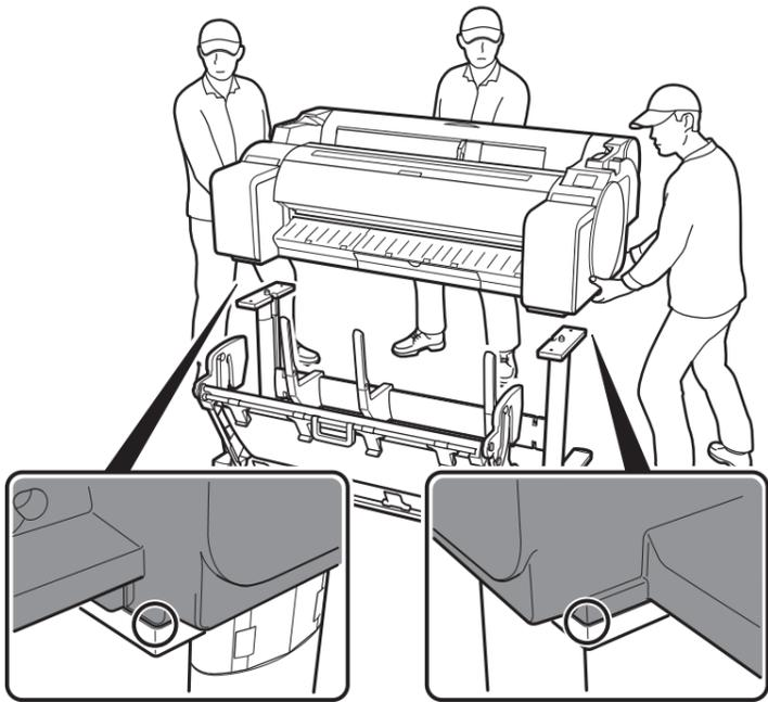
**5** 本体をスタンドに固定します。スタンド受け板の下側から、六角レンチを使用して、左右各2本のM4六角ビスでしっかりと固定します。
