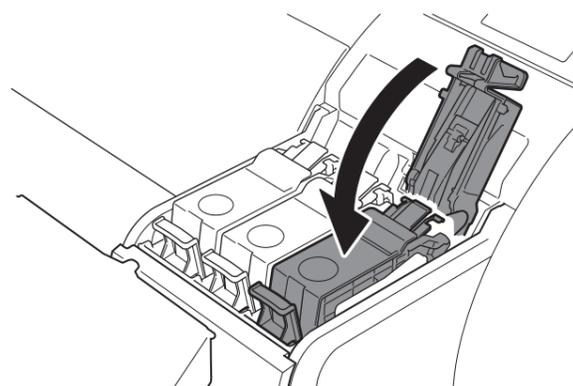
ラベルを見て、インクタンクが正しく取り付けられているか確認してください。
