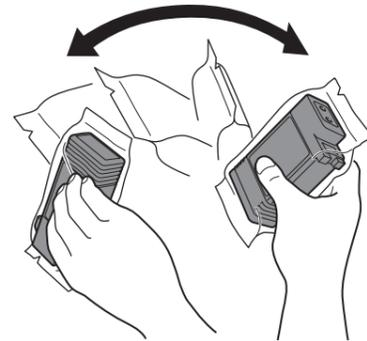
**重要** ・インクタンクを振らないと、インクの成分が沈殿し、印刷品質が低下する場合があります。
