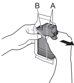
**重要** ・インク供給部 (A) や端子部 (B) には、絶対に触れないでください。周辺の汚損、インクタンクの破損、または印刷不良の原因になります。
